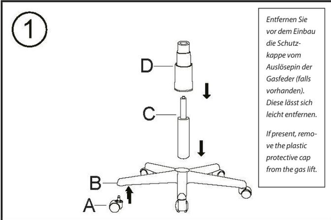
Entfernen Sie vor dem Einbau die Schutzkappe vom Auslösepin der Gasfeder (falls vorhanden). Diese lässt sich leicht entfernen.
